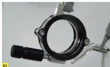
**X1:** Korrektur des Restastigmatismus der durch die seitliche Verkipfung des Kopfes entsteht. Durch drehen des Glases in der Halterung ist es möglich, den Achsenlagerpunkt in der Stellung zu verändern. Die Trefferquote wird verbessert.
