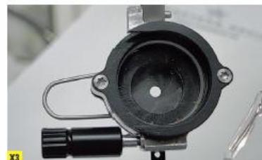
**X3:** Die als Zubehör erhältliche Einstelliris, ermöglicht eine nicht gekannte Präzisionseinstellung der Schiessbrille. Prismatische Fehler im Glas werden auf diese Weise eliminiert.
